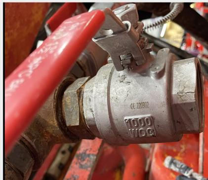
Vannes d'air de type ¼ de tour sphérique estampillée « 1000 WOG » (soit 63 bar, Water, Oil and Gas) adaptée à nos types de travaux.
