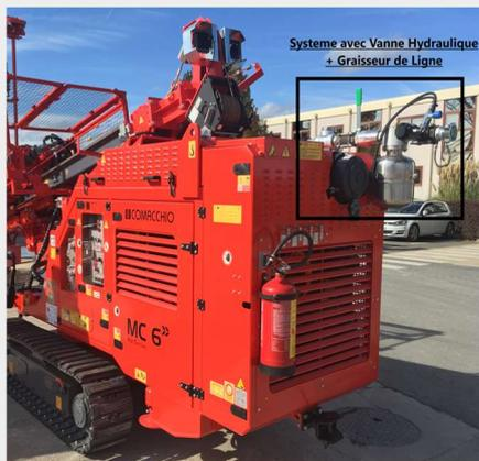
Il permet d'éviter l'oxydation prématurée de la ligne de forage à l'air rendant ainsi plus simple le desserrage des vannes et des raccords.
